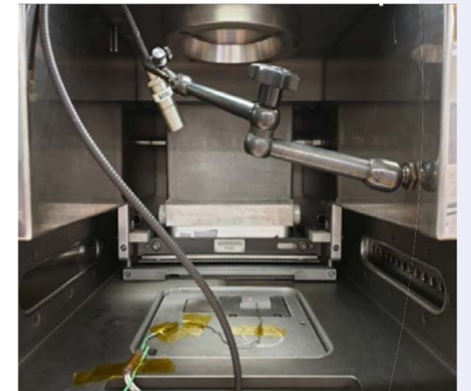
Bauraum der PBF-LB Anlage mit integrierter Sensorik zur Temperaturmessung
