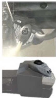
Spannpratze aus Hartmetall (WC83Co)
