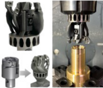
Topologieoptimiertes Glockenwerkzeug aus Stahl (X38CrMoV5-1)
