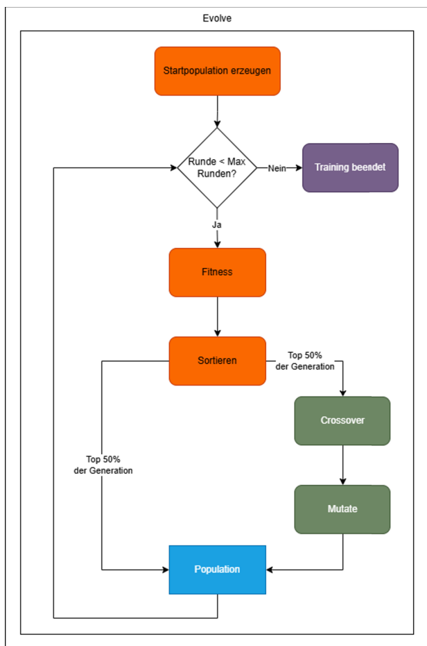
Abbildung 2: Ablauf des EA zur Parameteroptimierung
