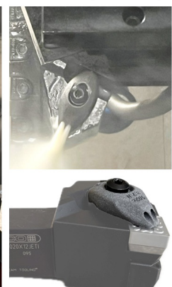
Spannpratze aus Hartmetall (WC83Co)
