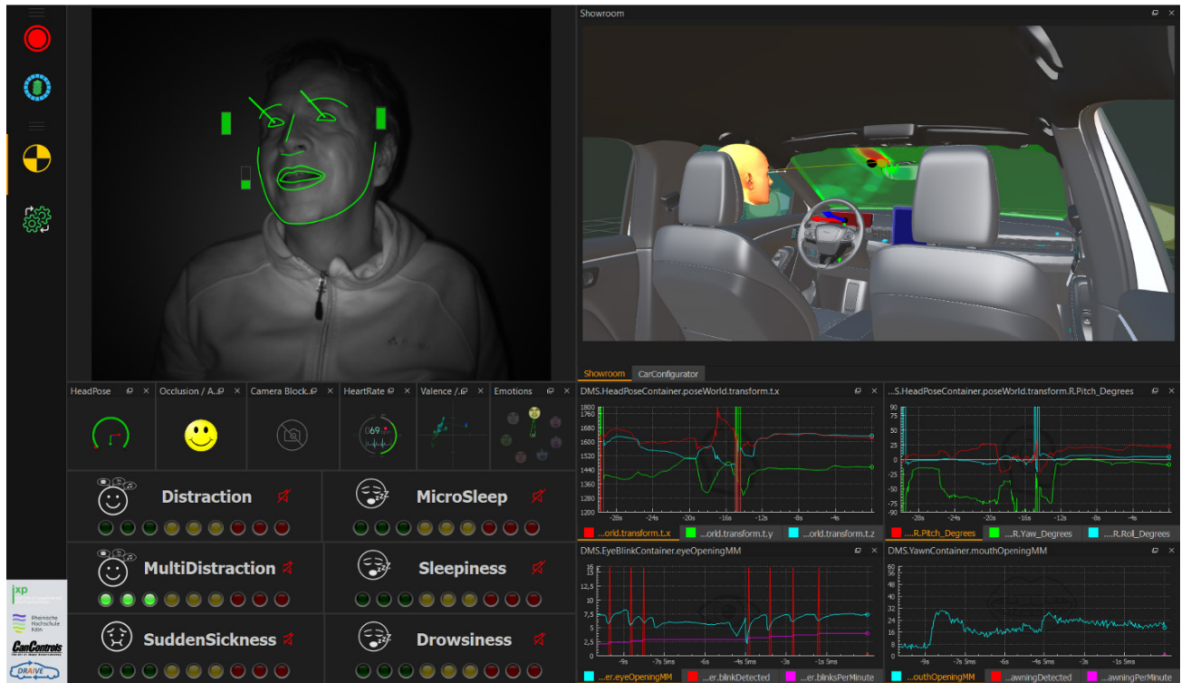
Der finale Demonstrator des Fahrerzustandserkennung-Systems (Projekt DrAlve), entwickelt von CanControls GmbH
