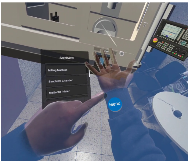
Abbildung 10: Ansicht eines Lernszenarios in der vRH-Factory: virtuelle Fräsmaschine mit Bedientafel in der VR-Umgebung. (Bildquelle: eigene Darstellung, Rheinische Hochschule Köln, Ansicht aus der VR-Anwendung)
