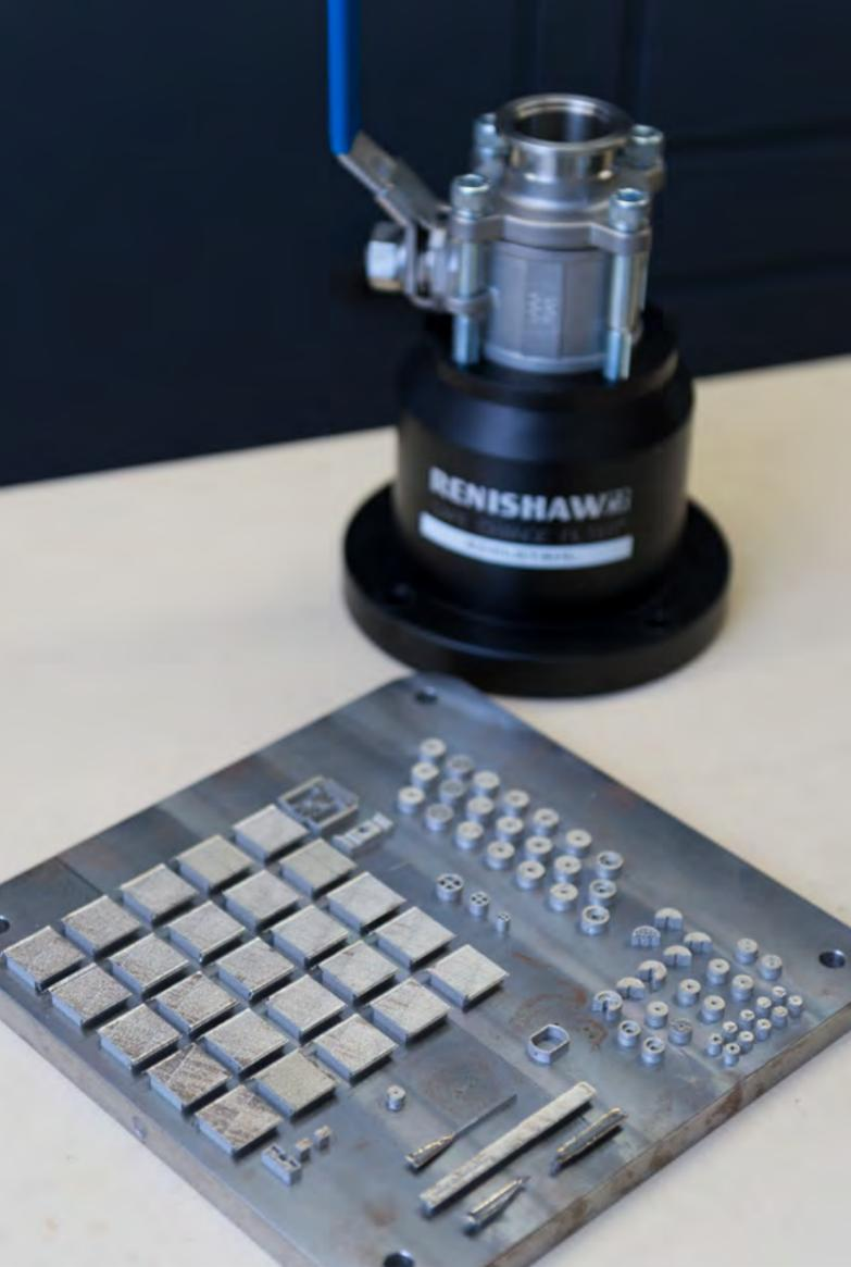
Bauplattform mit gedruckten Probekörpern aus Edelstahl
